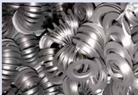
Grundet deres høje brudforlængelse (> 45 %) er de austenitiske stålqualiteter særdeles duktile og derfor lette at forme; her illustreret ved nogle opkravede flanger af EN 1.4404.
