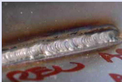
Makrofoto af svejsesøm i ferritisk 4521. Godstykkelse: er 2 mm, svejsemetode: TIG, tilsats: AISI 316LSi, Strøm: 90 A Beskyttelsesgas: ren Ar.
