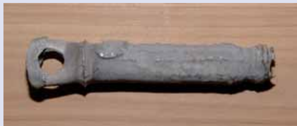
Rustfri bolt (4301) efter et længere ophold i stærk bejdsesyre (salpetersyre-flussyre). Bemærk, at korrosionstab er ganske ensartet og over det hele, og at mængden af tabt metal er ganske stor. Trods det imponerende materialetab er der endnu ikke sket gennemtæring.
