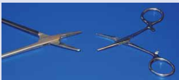
Kirurgiske instrumenter, begge fremstillet af martensitisk, rustfrit stål. Dette giver en høj styrke, men desværre en relativt ringe korrosionsbestandighed.
