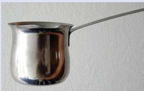
Ferritisk, rustfrit stål kan med fordel anvendes til emner med tyndt gods, store materialeomkostninger og enkel forarbejdning. Denne syrisk fremstillede kande er af 4016 (AISI 430), et meget anvendt materiale inden for catering. I øvrigt et glimrende eksempel på, at man kan dybttrække ferritisk, rustfrit stål.
