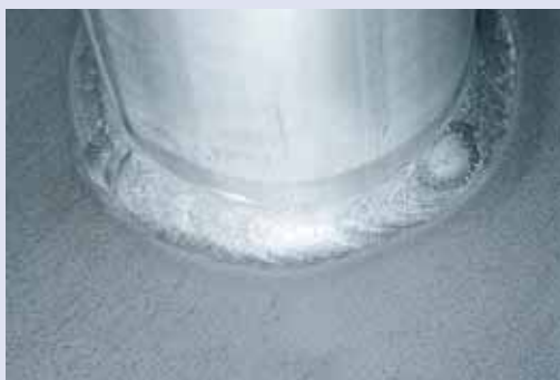
Bejdsset svejsesøm i et emne af 4404. Bemærk, at stålet får et "glansløst" udseende. Dette skyldes, at en bejdsning indebærer en ætsning af stålet, hvilket forøger overfladeruheden.
