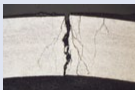
Spændingskorrosion udefra i rør af ståltype 4301. Korrosionen skyldes en kombination af varme indefra (60-70 °C) og kloridholdige vandsprøjt udefra.
